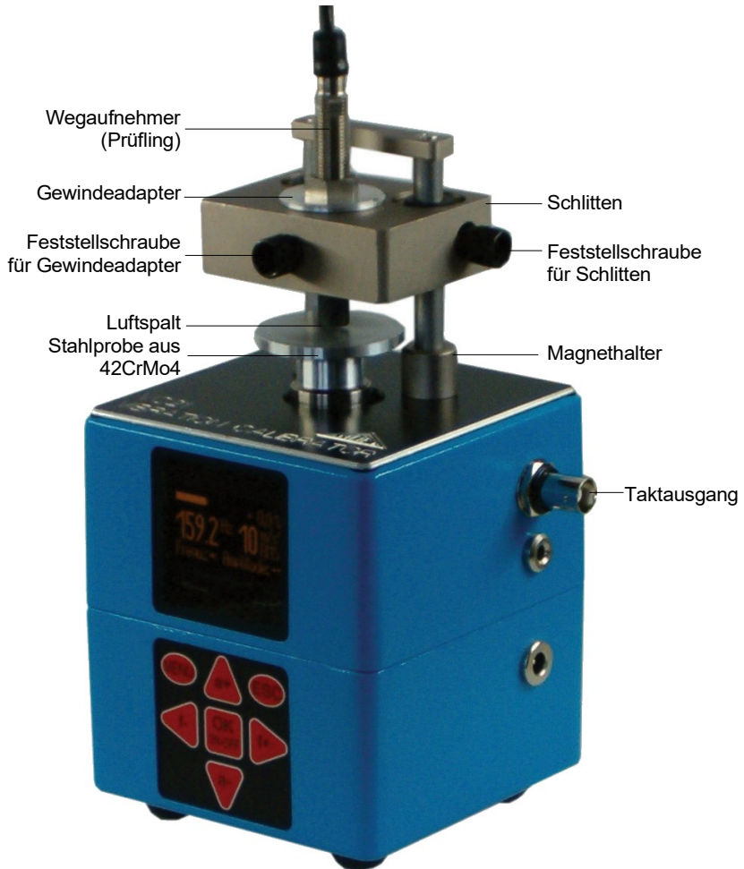
Bild 2: VC21D mit Adapter für Wegaufnehmer und Taktausgang
